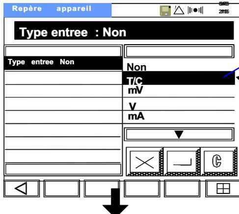
Sélectionnez ensuite les différents paramètres affichés dans la colonne de gauche et les configurer en entrant des valeurs numériques à l'aide du clavier ou des listes de choix apparaissant à droite.
